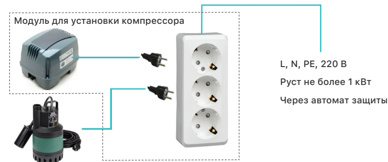
Рис. Принципиальная электрическая схема подключения станции
